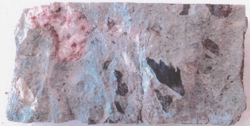
Obrázek č. 3: Fotodokumentace vývrtu 11/1-M1 – 2. polovina délky, pohled na zkoušenou lomovou plochu
